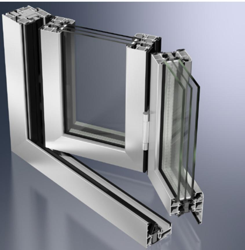
Mit dem hochwärmegedämmten Schüco Faltschiebesystem ASS 80 FD.HI bietet Schüco eine einzigartige Faltschiebetür, die einen  $U_f$ -Wert bis  $1,7\text{W}/(\text{m}^2\text{K})$  und einen  $U_w$ -Wert  $< 1,3\text{W}/(\text{m}^2\text{K})$  erreicht. Die Anforderungen der EnEV 2009 werden damit mühelos erfüllt. Schmale Ansichtsbreiten und große Typenvielfalt runden das Faltschiebesystem ab.
